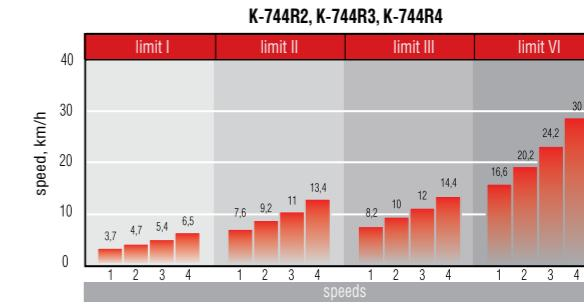
КПП Автоматизированная «T5», 16/8, четырехрежимная, с гидравлическим силовым переключением передач и пневмопереключением режимов
